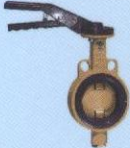
شیرهای پروانه‌ای بدون فلنج مخصوص آب دریا با اهرم DN: 50-200 mm PN: 6-16 bar & ANSI Class 150
